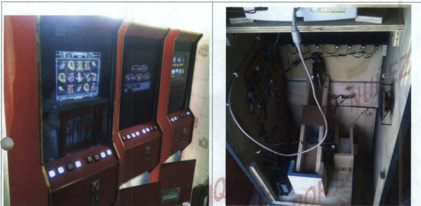
Figura Nro. 4 : Izquierda: Vista imagen frontal del gabinete de madera de la máquina de vídeo juego. Compuesta por pantalla y botonera. Se puede apreciar que admite monedas y posee bandeja de pagos. En el lado derecho: Vista posterior del gabinete abierto, en el se puede apreciar en la parte superior el dispositivo de imagen (monitor), la fuente de poder (energía eléctrica) y la placa de juegos, la que se presentará en detalle en fig. siguientes.
